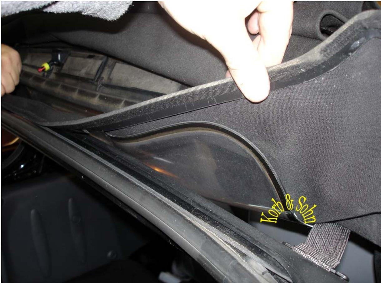
Nun muss unterhalb des Spoilers noch die Kunststoffleiste demontiert werden.
