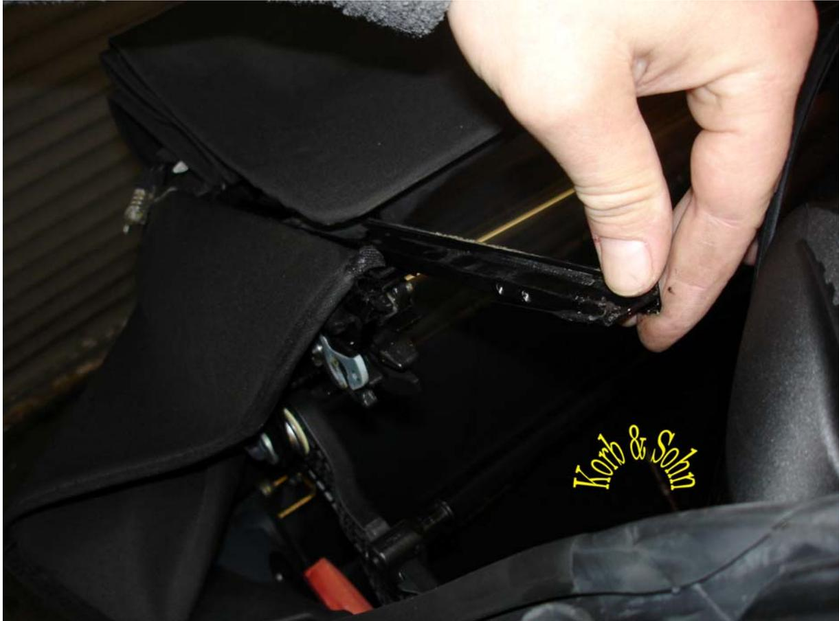
Das Heckteil ist an diesen Stellen einfach nur mit einer Kunststoffleiste eingesteckt.
