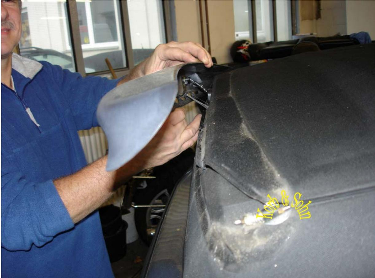
Hier sitzt der Stecker der Bremsleuchte. Diesen Wegdrücken der seitlichen Sperre lösen.
