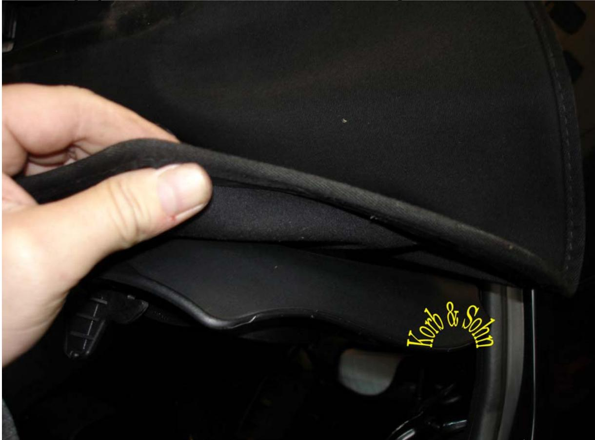
Oberhalb des Kofferraumdeckels ist der Dichtgummi an zwei Stellen eingehakt (aushängen).
