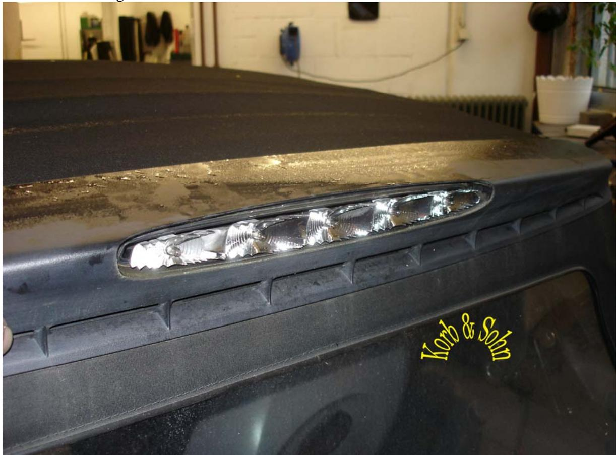
Unter den Blenden (einfach abziehen) liegen die Schrauben des Heckspoilers. Diese entfernen
