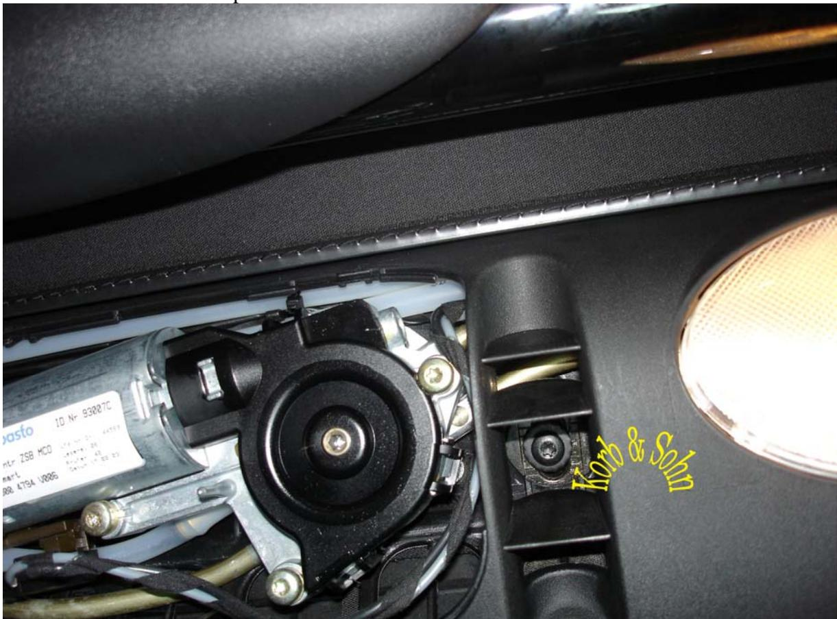
Wenn die oben gezeigten Schrauben entfernt wurden, kann die Leiste abgehoben werden.
