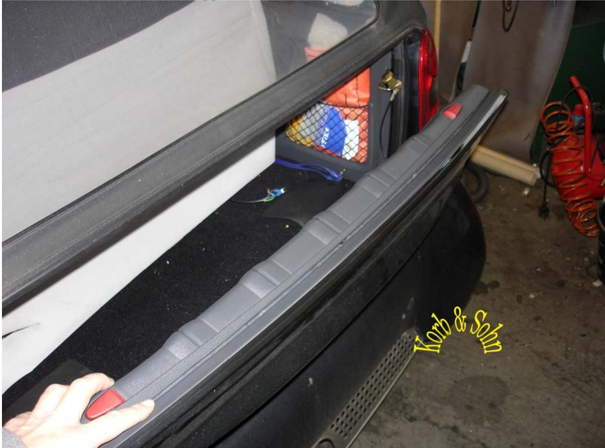
Nun wird das dritte Bremslicht entfernt. Dazu diese Kreuzschrauben entfernen.
