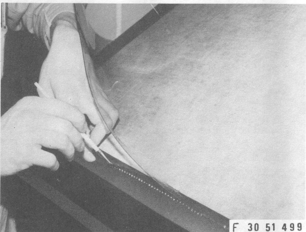
Kleber im unteren Bereich der Heckscheibe auf Verdeck auftragen.
